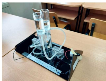
Fig. 8. Separarea hidrogenului de oxigen Dispozitiv experimental
