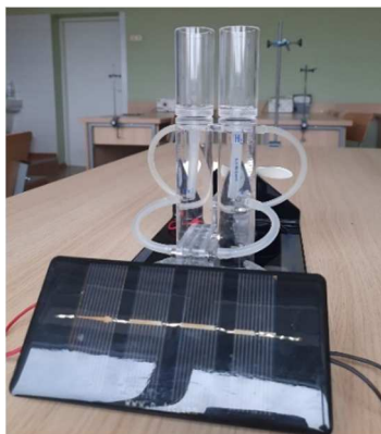
Fig. 7. Umplerea rezervoarelor cu apă distilată Dispozitiv experimental
