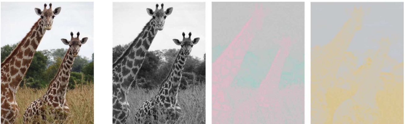
Fig. 2. De la stânga la dreapta: imaginea RGB; canalul L în spațiul de culoare CIELAB, echivalent luminozității; canalul a, reprezentând spectrul de culori de la verde la roșu; canalul b, reprezentând spectrul de culori de la albastru la galben
